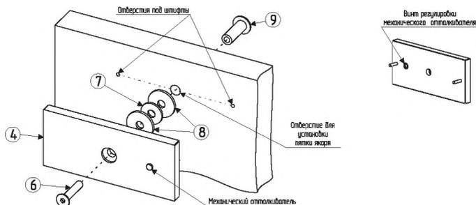
Рисунок 3. Схема установки электромагнитного замка и крепежного уголка.
