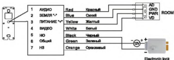
Схема подключения с электромеханическим замком
