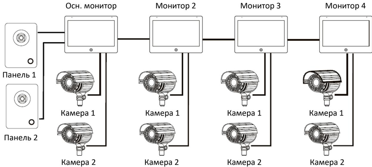
Максимальная конфигурация системы: один основной монитор, три дополнительных монитора, две вызывные панели, 8 дополнительных видеокамер.
